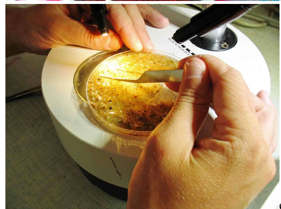
Figure 7 : Opération de rinçage des eaux de fixation puis de lavage à grande eau (a), tri hydraulique (b), coloration des refus de tamis (c) et rinçage (d) puis de tri à la binoculaire des éléments les plus fins.
