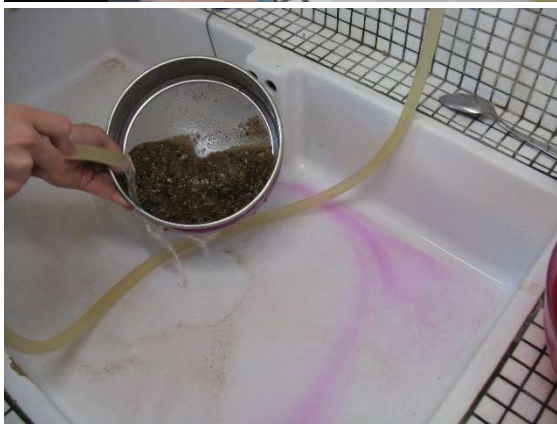
Figure 7 : Opération de rinçage des eaux de fixation puis de lavage à grande eau (a), tri hydraulique (b), coloration des refus de tamis (c) et rinçage (d) puis de tri à la binoculaire des éléments les plus fins.
