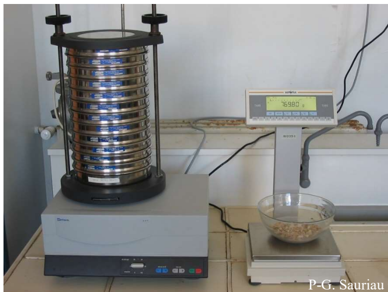
Figure 5 : Colonne de tamis normalisés AFNOR sur tamiseuse Retsch et balance Sartorius à 0,01 g. Photo P.-G. Sauriau CNRS ©.
