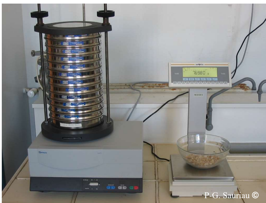
Figure 7 : Colonne de tamis normalisés AFNOR sur tamiseuse Retsch et balance Sartorius à 0,01 g. Photo © CNRS / Sauriau P.-G. 2008.
