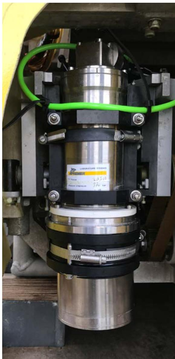
Mise en place de la camera hyperspectrale en-dessous de la caméra science en position verticale © Ifremer
