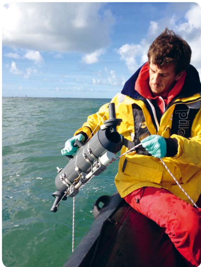
PRÉLÈVEMENTS AU LARGE DE LA LOIRE DANS LE CADRE DE LA MISE EN PLACE D'UNE STATION D'OBSERVATION POUR LE REPHY QUI SERVIRA AU COMPTAGE DU PHYTOPLANCTON ET À MESURER LES PARAMÈTRES GÉNÉRAUX DE LA COLONNE D'EAU (TEMPÉRATURE, SALINITÉ, OXYGÈNE DISSOUS ET TURBIDITÉ). © Ifremer
