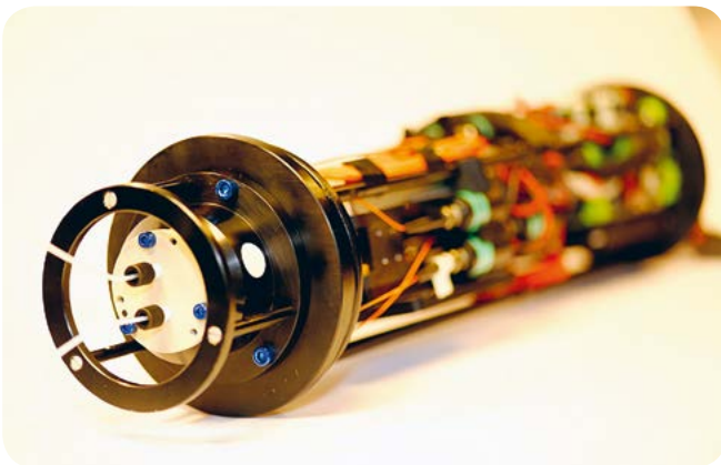
LE NOUVEAU CAPTEUR SPRi DÉVELOPPÉ PAR L'IFREMER EST CONÇU POUR DÉTECTER LES BIOTOXINES COMME L'ACIDE DOMOÏQUE DANS LA MER © Ifremer
