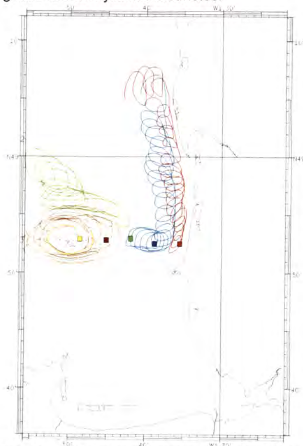
figure 19 : simulations de trajectoires de particules fictives lâchées entre Chausey et la Côte Ouest cotentin réalisées au moyen du modèle hydrodynamique 2D WCOT développé dans le cadre du CPER Basse- Normandie /CRBN/AESN/CG50/CG14)
