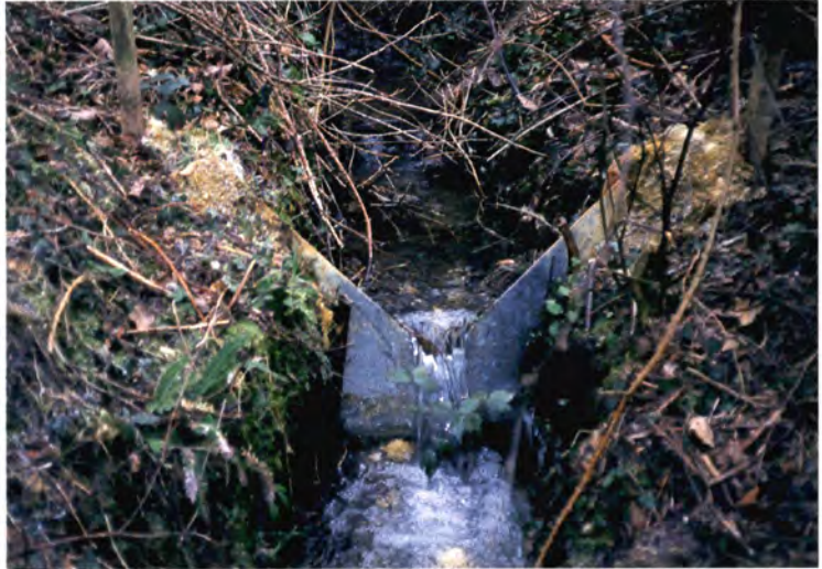
Figure 3 Exemple d'un seuil à paroi mince installé sur les points de suivi hydrologique 1996-1997, 1997-1998.
