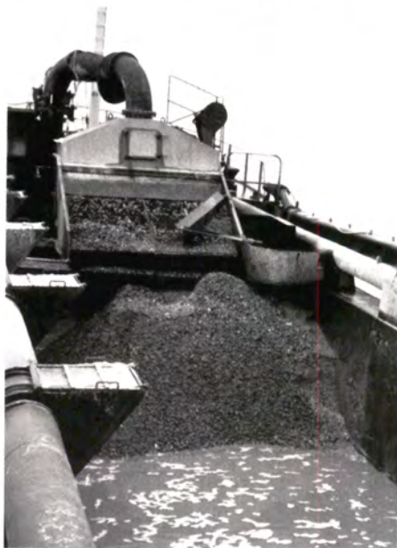
6d - Remplissage de la cale par les crépidules.
