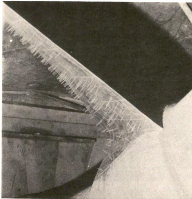
Photo N° 10 : intrados de la pale après mise en place d'une allumette dans chaque trou provoqué par la corrosion.
