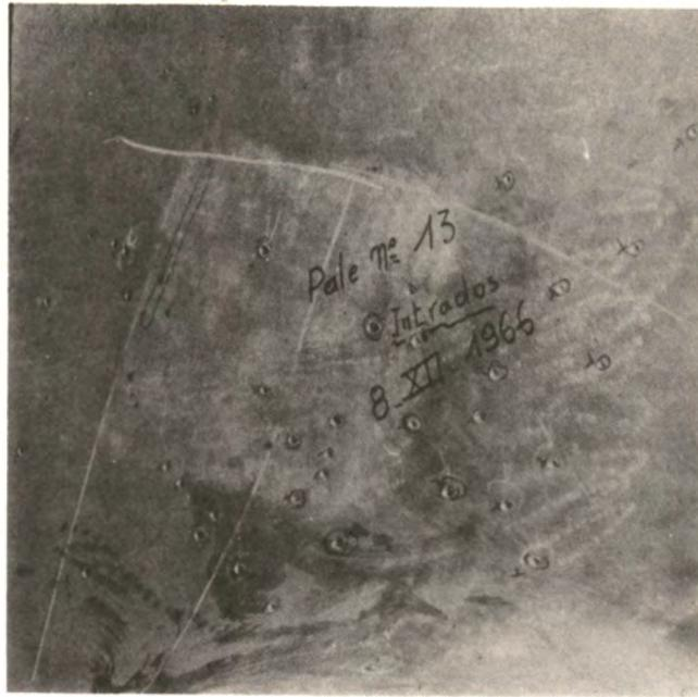
Photo N° 9 : la même pale après nettoyage et fraisage des trous provoqués par la corrosion.
