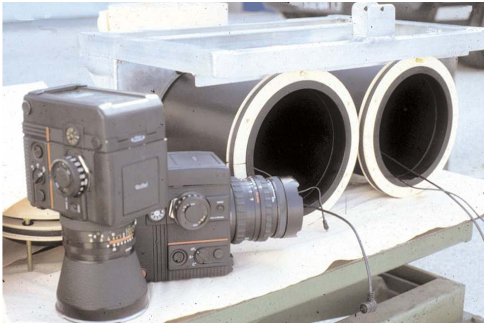
Fig. 12 – Utilisation et conditionnement dans des enceintes étanches d'appareils de prises de vues semi-métriques
