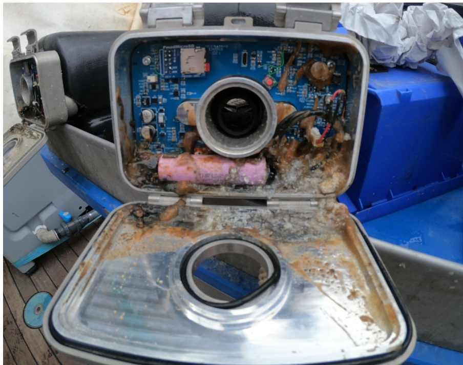
Figure 11. État d'un boîtier après 24h d'immersion par 40m de fond. L'eau s'est infiltrée par la résine fixant le capteur et a amorcé une réaction électrolytique avec la batterie, rendant le prototype inutilisable.
