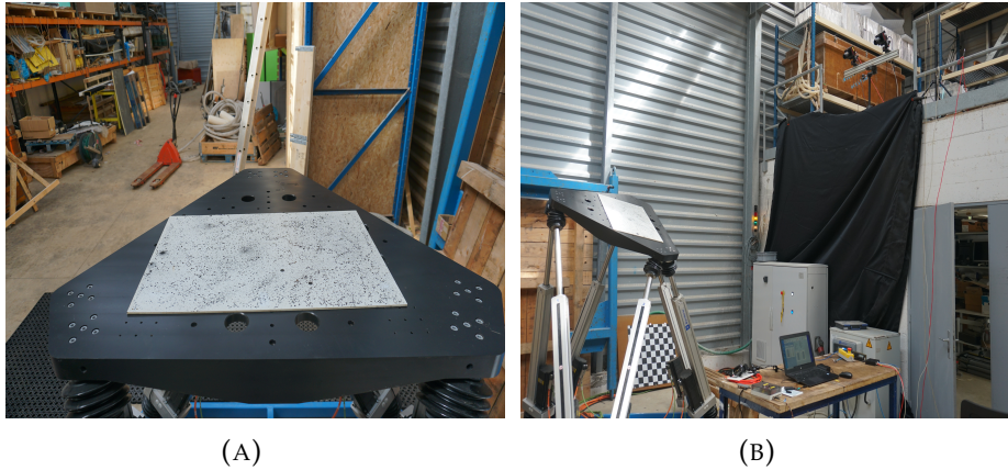
FIGURE 3.3 – (A) : Mouchetis collé sur l’hexapode. (B) : Montage hangar, caméras placées en hauteur en haut à droite.
