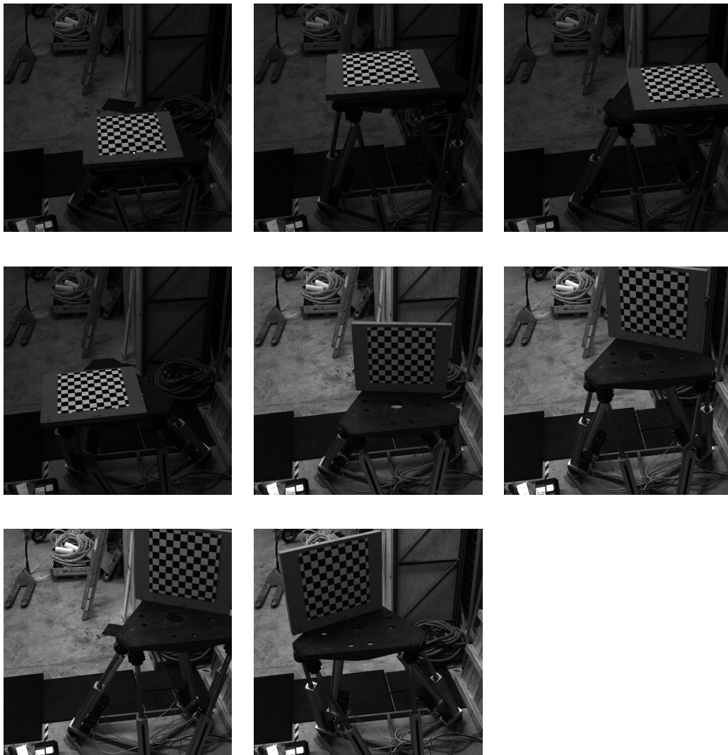
FIGURE A.1 – Images d'étalonnage des tests préliminaires de la caméra de gauche sur l'hexapode
