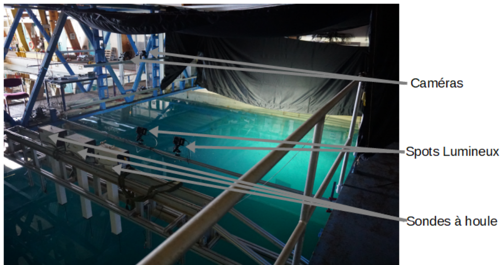
FIGURE 3.7 – Montage de l'expérimentation, luminosité ambiante supérieur à celle lors des essais
