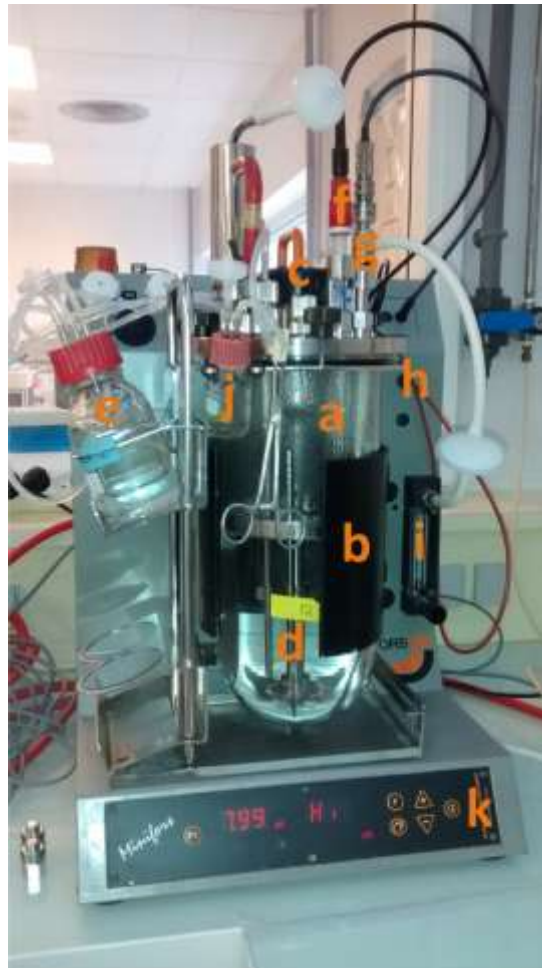
Figure 28. Composants d'un bioréacteur Minifors 5 L (INFORS).
