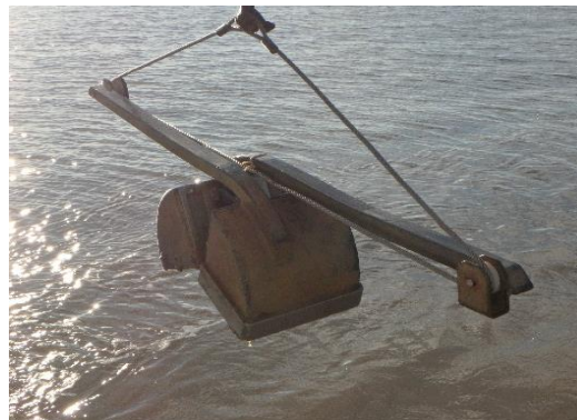
Figure 2 : Mise en œuvre de la benne van Veen
