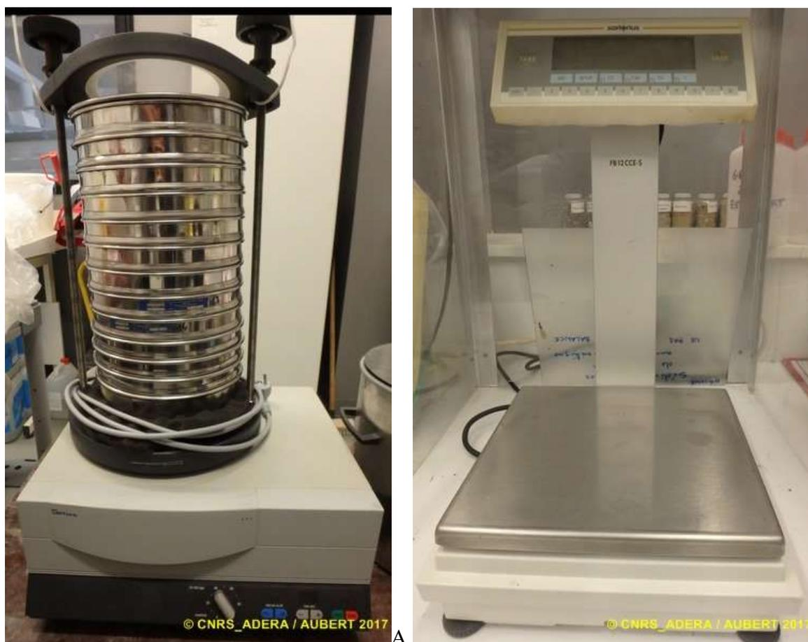
**Figure 13** : Colonne de tamis normalisés AFNOR sur tamiseuse Retsch (A) et balance Sartorius à 0,01 g (B).
