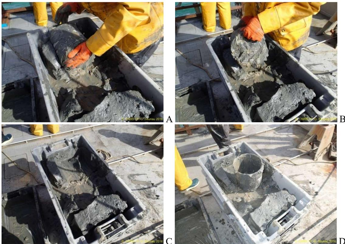
**Figure 6** : Déroulement des opérations lors d'un prélèvement au carottier sur le volume prélevé à la benne Smith-McIntyre (A : carottier rempli, B : carottier manipulé, C : volume prélevé et D : carottier vide). Photo P.-G. Sauriau CNRS ©.
