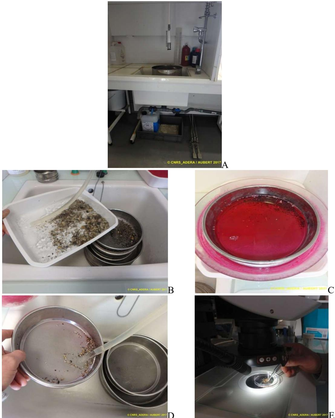
**Figure 16** : Opération de rinçage des eaux de fixation puis de lavage à grande eau sous Sorbonne (A), tri hydraulique (B), coloration des refus de tamis (C) et rinçage (D) puis de tri à la loupe binoculaire des éléments les plus fins.
