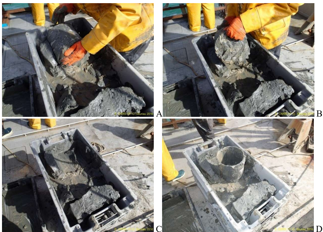
Figure 6 : Déroulement des opérations lors d'un prélèvement au carottier sur chacune des 3 sous-stations intertidales et illustration d'un répliat de prélèvement faunistique par carottier sur le volume prélevé à la benne Smith : carottier rempli (A), carottier manipulé (B), volume prélevé (C) et carottier vide (D). Photo P.-G. Sauriau CNRS ©.
