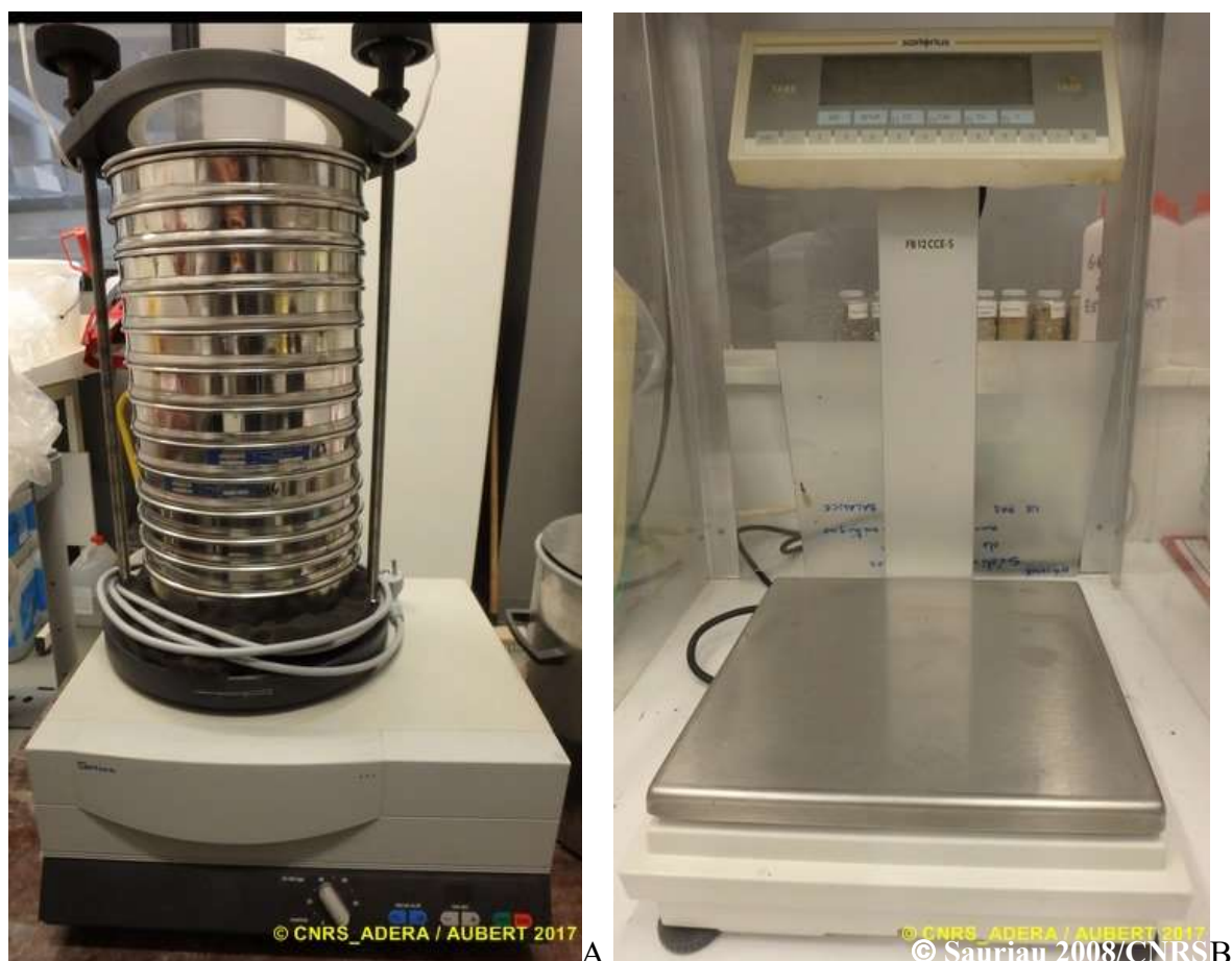
Figure 11 : Colonne de tamis normalisés AFNOR sur tamiseuse Retsch (A) et balance Sartorius à 0,01 g. (B).
