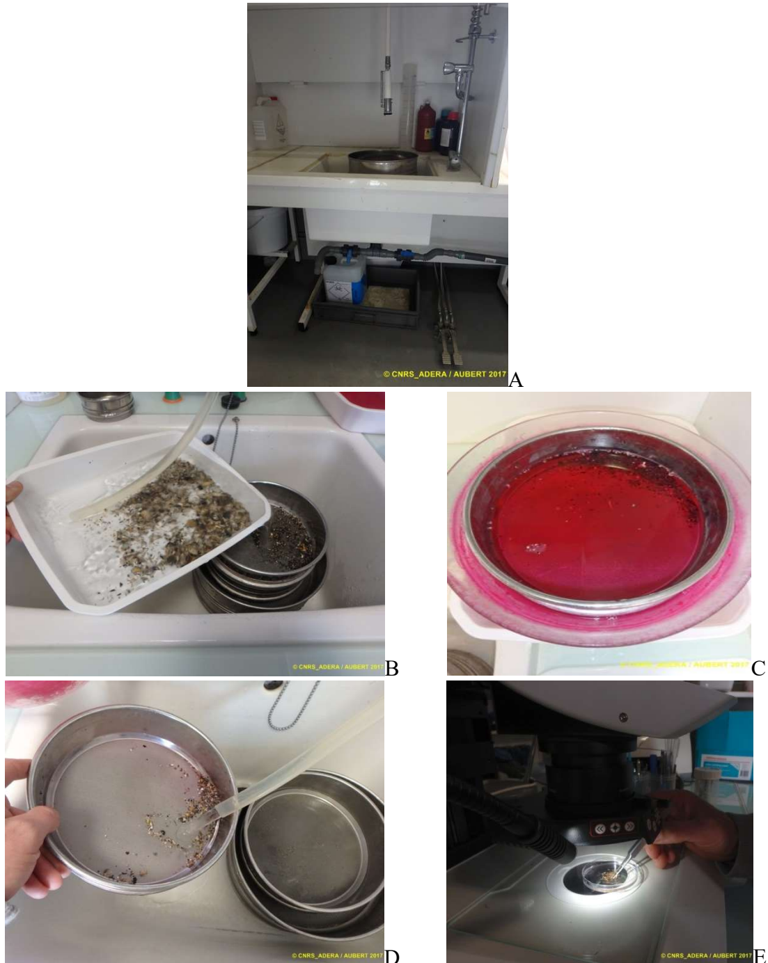
Figure 14 : Opération de rinçage des eaux de fixation puis de lavage à grande eau sous Sorbonne (A), tri hydraulique (B), coloration des refus de tamis (C) et rinçage (D) puis de tri à la loupe binoculaire des éléments les plus fins.
