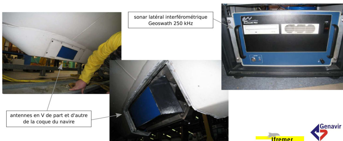
FIGURE 5.12 – Disposition des antennes du sonar latéral interférométrique Geoswath 250 kHz, de part et d'autre de la coque de la V/R Haliotis de l'IFREMER.
