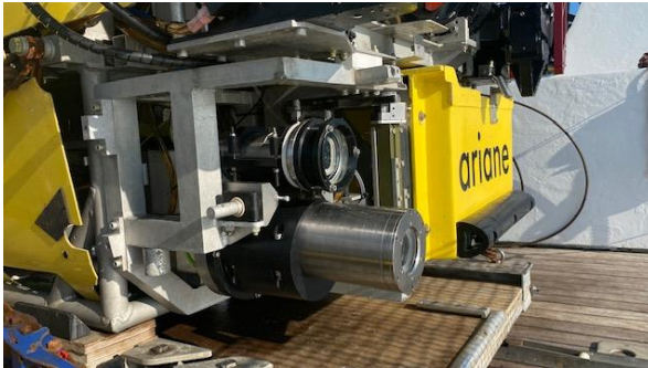
Camera HYPERSPECTRAL en lieu et place de l'APN
