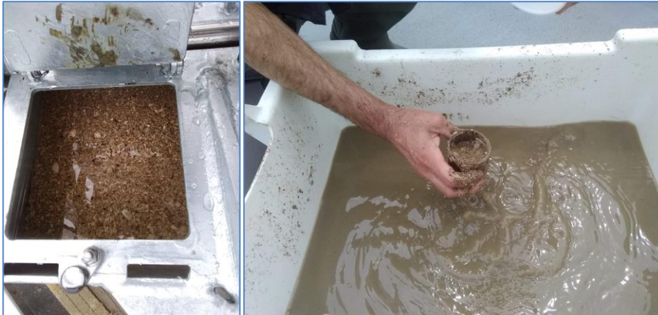
Figure 7 - Prélèvement benne : échantillonnage interface eau/sédiment (à gauche) et mélangé (à droite)
