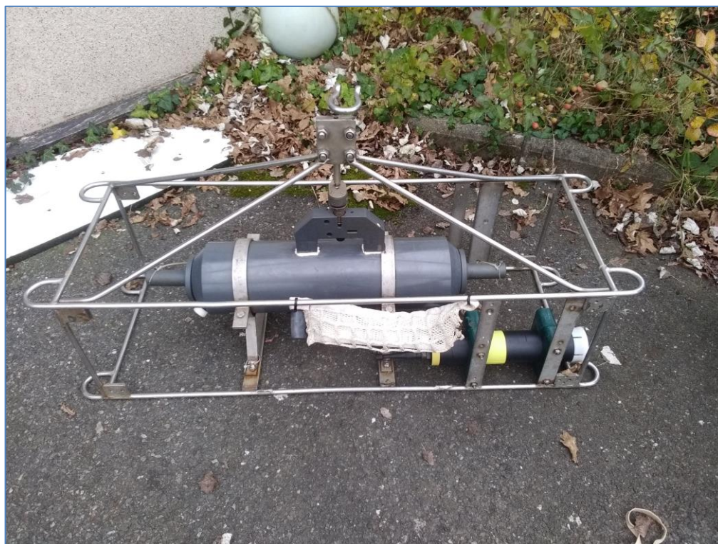
Figure 2 - Cage Niskin pour profils verticaux CTD + Turbidité.
