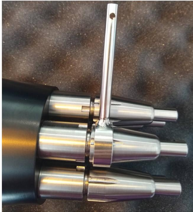
Retirer délicatement la sonde test jusqu'à l'apparition de la connectique avec le câble SMC
