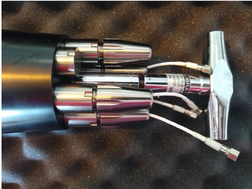
Retirer le cône en faisant passer les câbles SMC :
