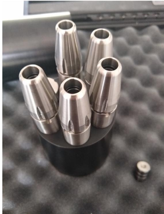
Refaire passer les câbles SMC et revisser les sondes test en respectant bien la concordance des références indiquées sur les sondes et sur les câbles. Attention à ne pas vriller les câbles SMC
