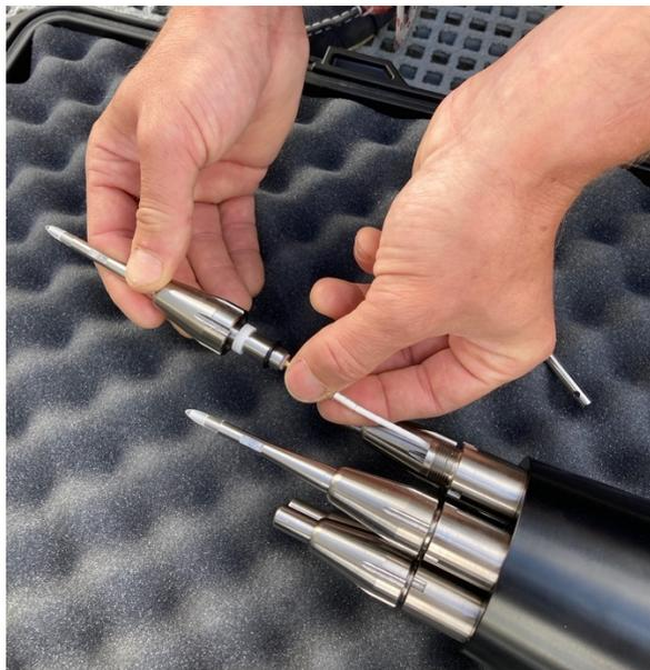
Lors de la mise en place des sondes on relève leur code d'identification ainsi que le coefficient associé qui sera entré dans le fichier de configuration setup.cfg.
