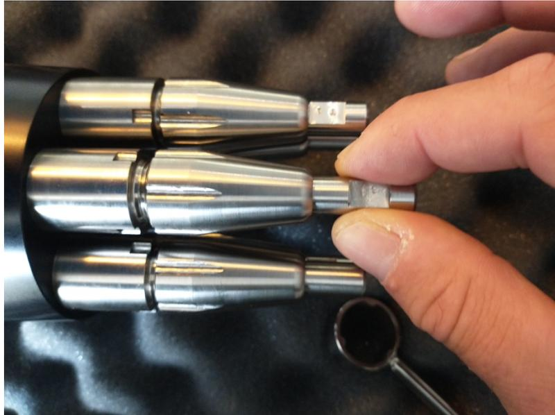
Le serrage du capuchon du porte-sonde s'effectue en deux temps. D'abord, visser le capuchon à la main jusqu'à ce qu'il ne soit plus possible de visser facilement à la main. Puis, à l'aide de la clé spéciale, serrer d'un 1/8 ou ¼ de tour supplémentaire.
