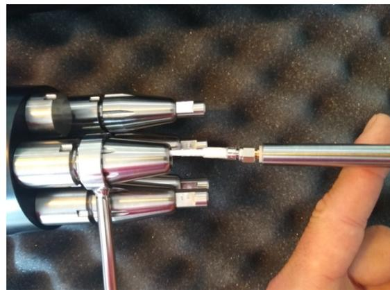
Dévisser la sonde test en évitant une torsion du câble SMC
