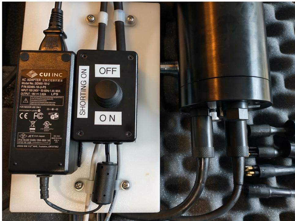
Le bouton du boîtier « SHORTING ON » doit être en position OFF.
