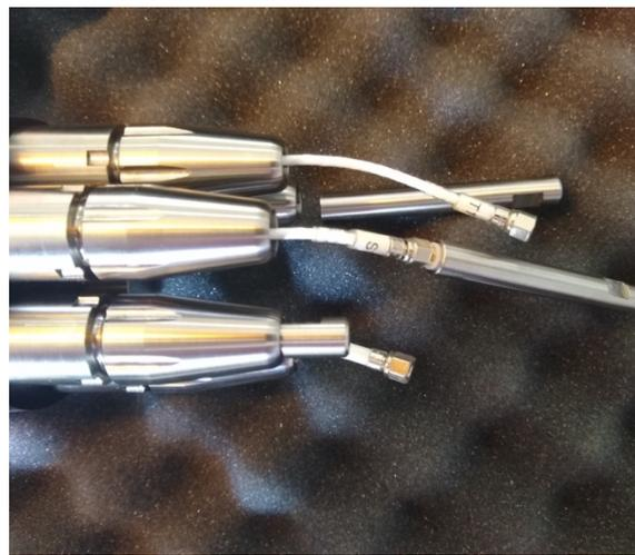
Insérer la sonde dans le capuchon et enfoncer la sonde jusqu'à entendre la base métallique de la sonde rentrer en contact la base métallique du porte-sonde :
