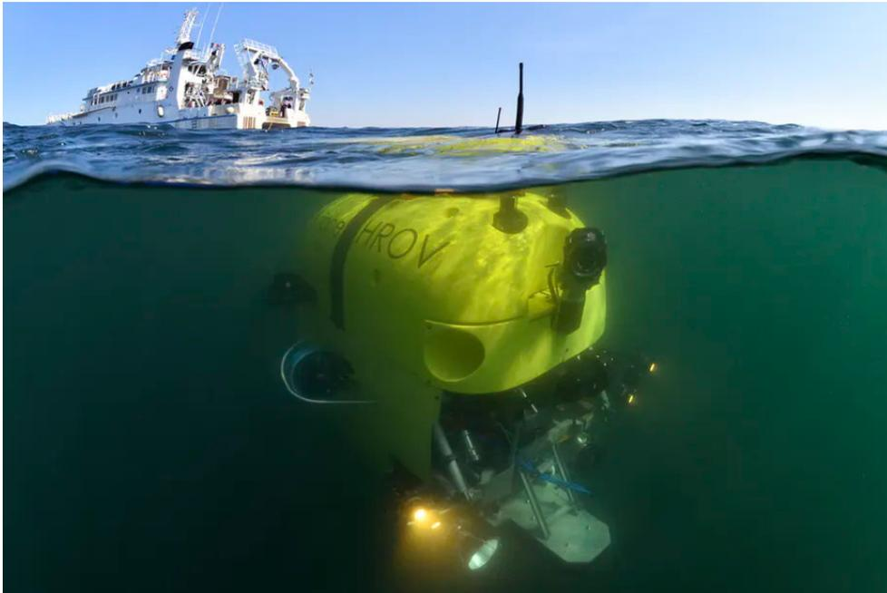
Le robot submersible Ariane, utilisé dans des missions de prélèvement, d'inspection ou de cartographie, peut descendre jusqu'à 2500 mètres de profondeur. Olivier Dugornay / Ifremer, CC BY-NC-ND
