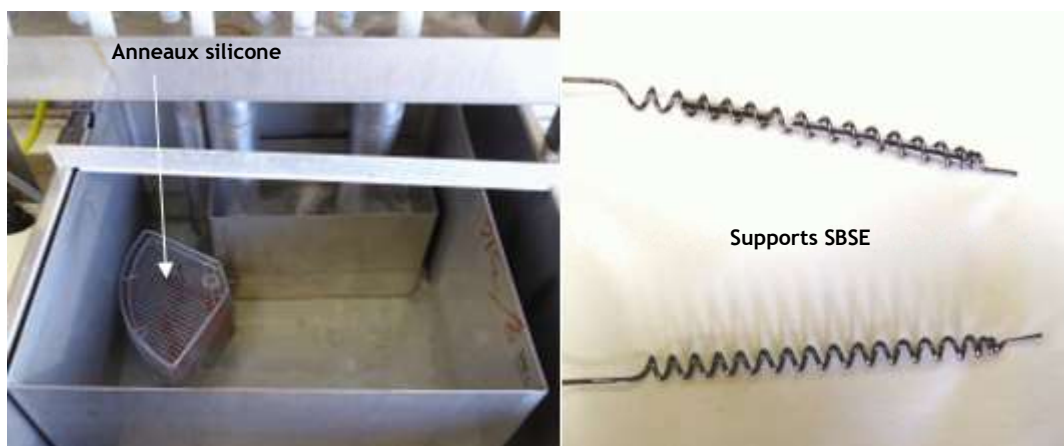
Figure 6 : banc SBSE avec les anneaux de silicone, et support pour barreaux SBSE
