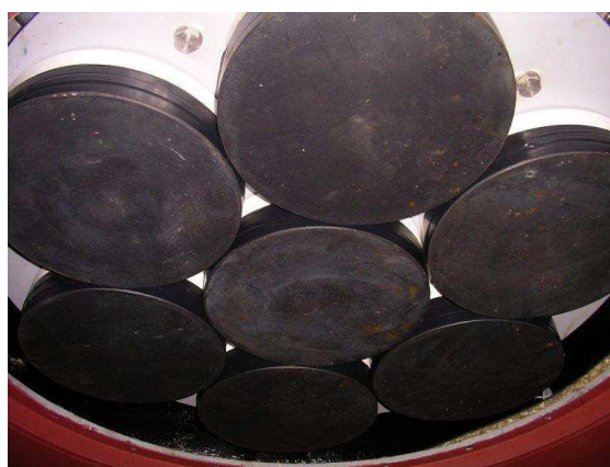
Figure 1 : Antenne : 7 transducteurs Tonpizl (résonances à 2 et 5 kHz, montés en parallèle) Position de la base : dx= 0.0 ; dy=+31 m / point de référence
