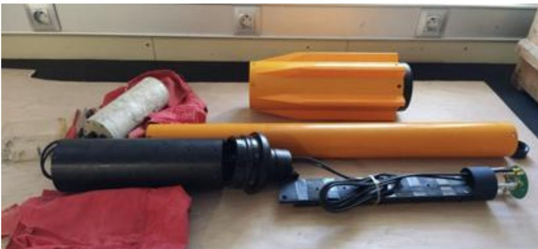
Figure 233 : Magnétomètre SeaSPY2 démonté suite à la défaillance du capteur Overhauser (en haut à gauche)
