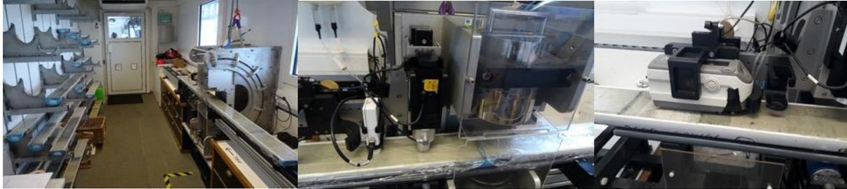
Figure 96 : Gauche : Installation du container MSCL du N/O Marion Dufresne avec les racks de rangement. Milieu : de gauche à droite, capteurs de susceptibilité magnétique, P-wave et Gamma radiation. Droite : spectrophotomètre.
