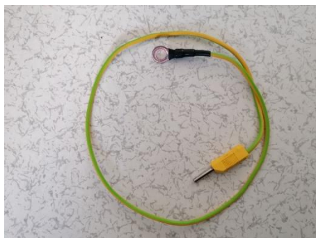
Figure 17 : Petit câble de masse.
