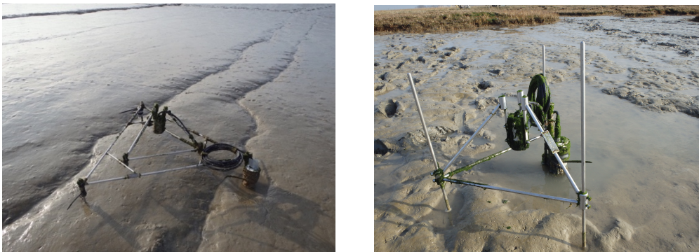
Figure 9. Mise en place d'altimètres ALTUS sur le site de la Vasière Nord en estuaire de Seine [HYMOSED-SA5].
