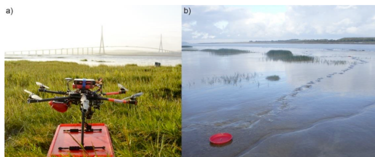
Figure 12. (a) Mise en œuvre du drone et (b) exemple de cible utilisée pour le référencement DGPS.
