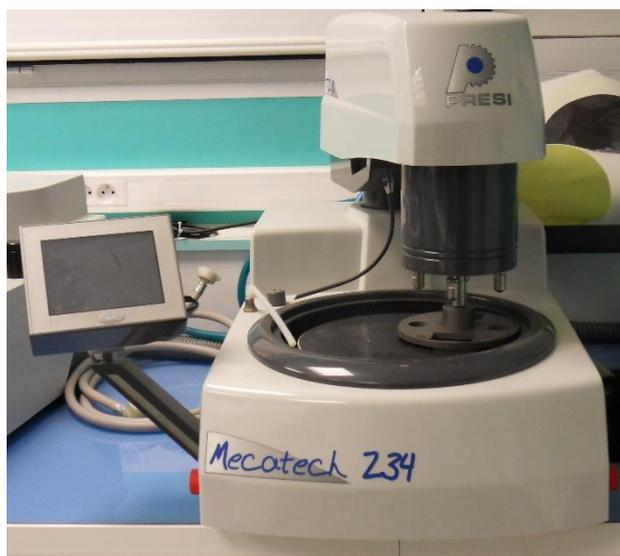
Figure 5 : Polisseuse automatique utilisée au pôle Sclérochronologie.
