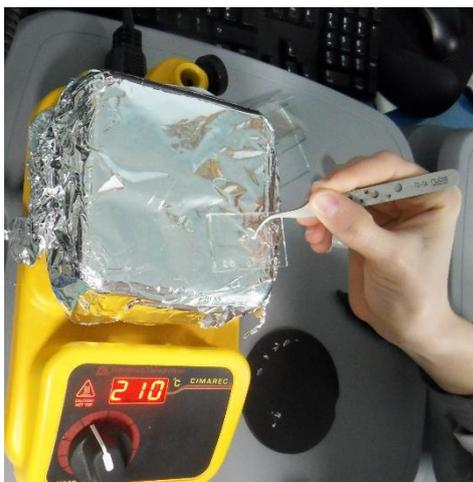
Figure 4 : Encollage des otolithes d'anguilles communes à 210°C sur une lame de verre type lame de géologie.
