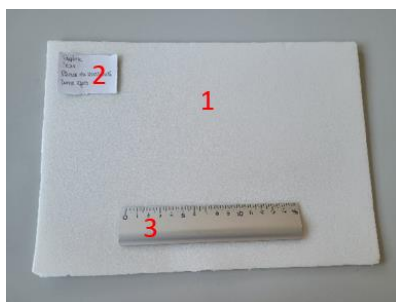
Figure 1. Plan de travail de prise de photo des gonades de poisson: 1) Fond blanc, 2) Papier d'identification, 3) règle millimétrée.
