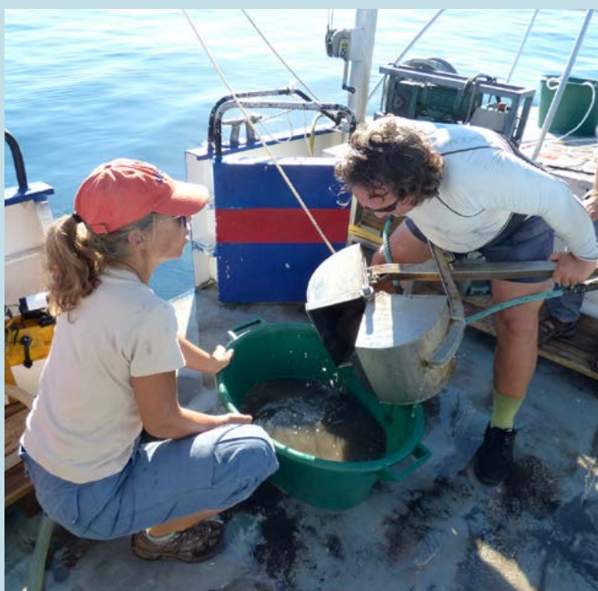
Prélèvement de sédiment à la benne de type Van Veen © Université de la Réunion
