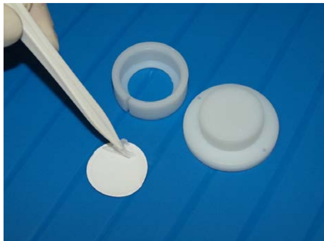
Échantillonneur, capteur passif (DGT™) © AEL
