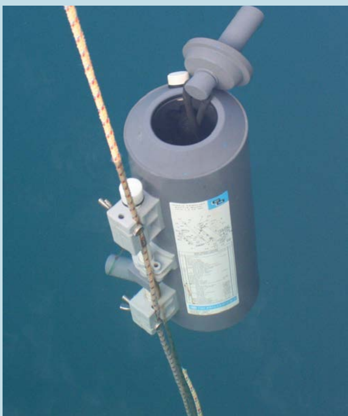
Bouteille de prélèvement Niskin™ pour le dosage des sels nutritifs © AEL
