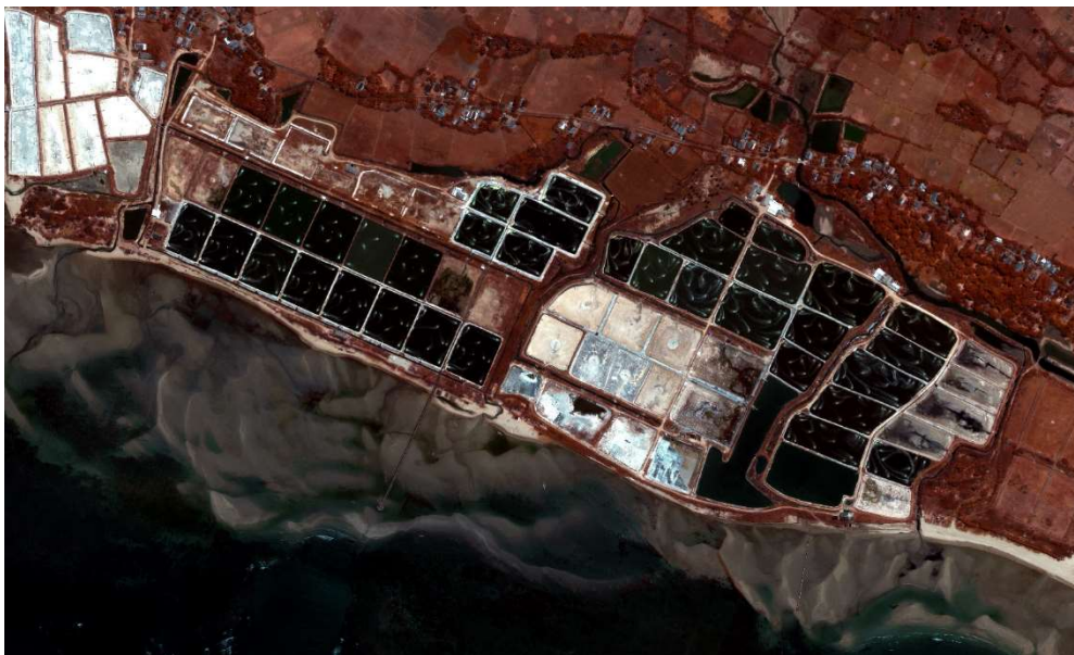
Figure X-1. Image satellite à très haute résolution spatiale d'une ferme super-intensive en Sulawesi du Sud (Site de Takalar) (25 février 2014). On distingue parfaitement bien les bassins mais aussi les aérateurs que l'on peut compter au sein de chaque structure. On distingue facilement les bassins en eau et ceux en cours d'assèchement.
