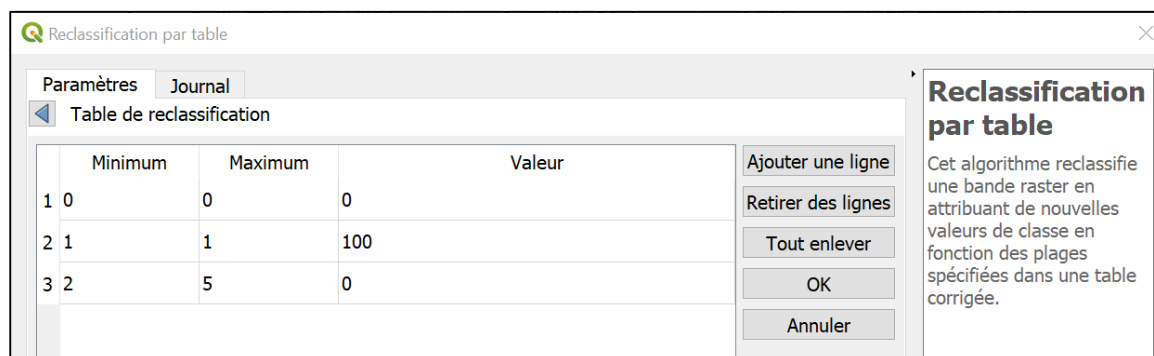
Figure A8 : Options de la table de reclassification de l'outil « Reclassification par table ».
