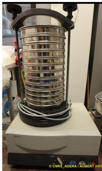
Figure 20 : Colonne de tamis normalisée AFNOR sur tamiseuse Retsch
