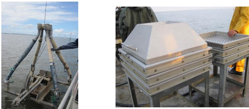
Figure 4. Mise en œuvre de la benne Hamon (godet de 0,25 m<sup>2</sup>) et tables de tri composées de trois tamis de maille carrée de 20, 10 et 5 mm. L'utilisation d'un couvercle ouvert à son sommet, pourvu de petites gouttières permet de limiter les projections d'eau et la perte des petites palourdes.
