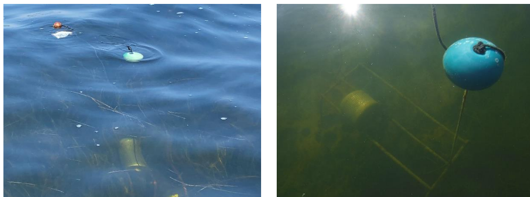
Figure 3 : Photo des mouillages (tables autonomes) utilisés pour l'exposition des POCIS au cours de la campagne OBSLAG (à Bages sud à gauche et La Palme à droite).
