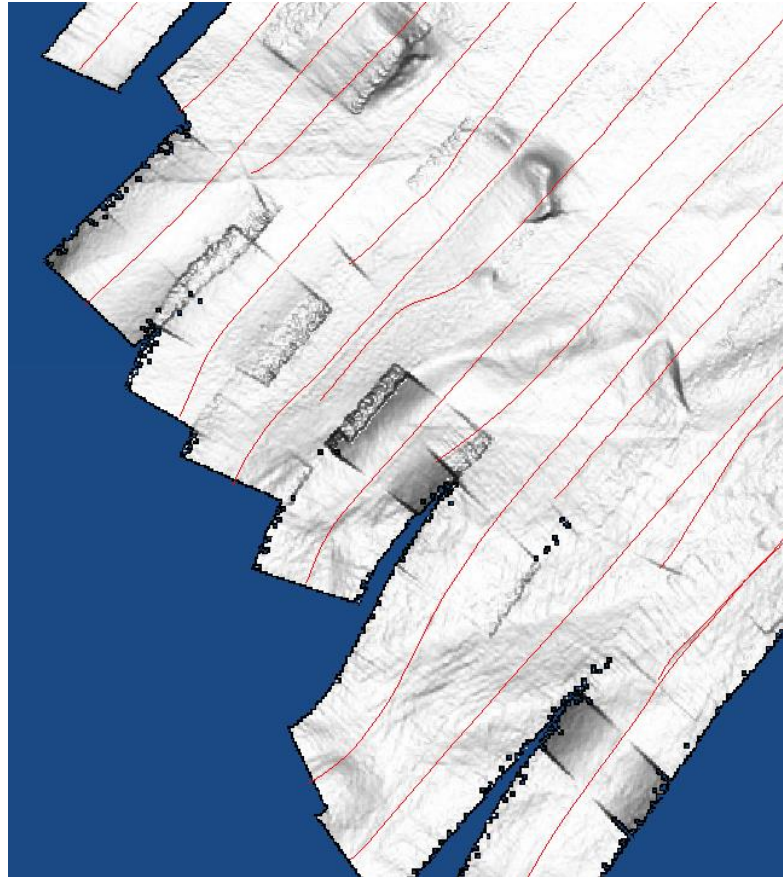
Figure 12: Illustration des problèmes de célérimètre
