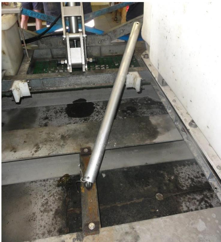
Le tube de guidage est solidarisé sur l'anneau de levage à l'aide d'une garcette en Dyneema  $\varnothing 4$ . Laisser une sur longueur sur la garcette pour permettre de lever le tube de guidage. Ceci permet de visualiser que la pointe de la tige TIPS est bien passée au travers du perçage inférieur du châssis MACS.
