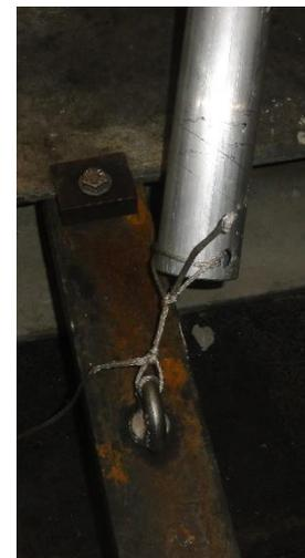
Deux garcettes liées à la partie haute du tube sont passées au travers du châssis MACS.
