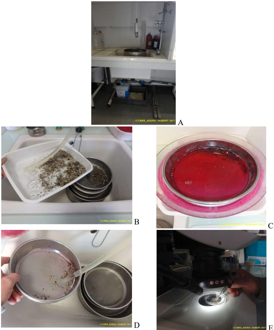
**Figure 13 :** Opération de rinçage des eaux de fixation puis de lavage à grande eau sous Sorbonne (A), tri hydraulique (B), coloration des refus de tamis (C) et rinçage (D) puis de tri à la loupe binoculaire des éléments les plus fins.
