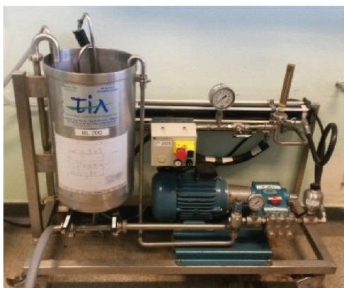
Figure 40 : Photo et schéma du pilote d'osmose inverse (EPOC-LPTC, Université de Bordeaux).
