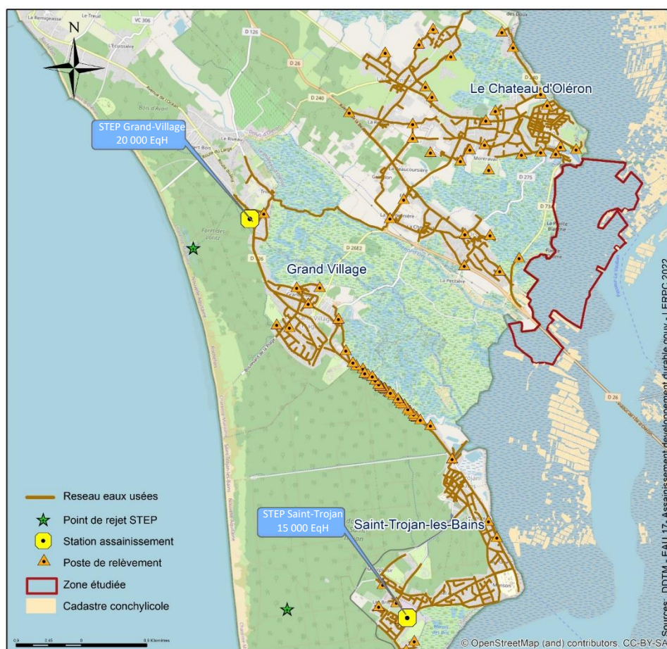
Figure 16. Système d'assainissement collectif dans le secteur des communes de Grand-Village, Le Château d'Oléron et Saint-Trojan (source -EAU 17)
