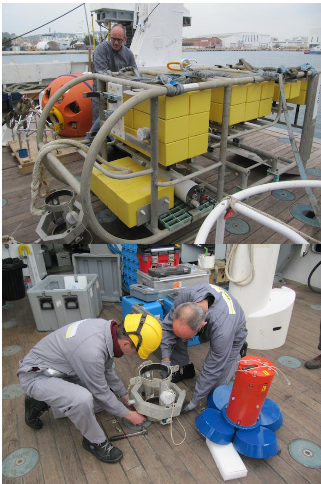
Figure 7 : Préparation des mouillages sur la plage arrière du N/O L'Europe, à quai le jour de la mobilisation du leg CASSISED-2019-1
