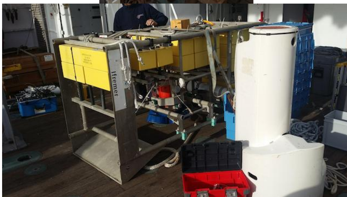
Figure 8 : (haut) bouée de flottabilité PeerGynt contenant également l'ADCP 300 kHz ; (bas) chassis et flottabilité Aniitra contenant l'ADCP 75 kHz (à droite, le piège à particules)
