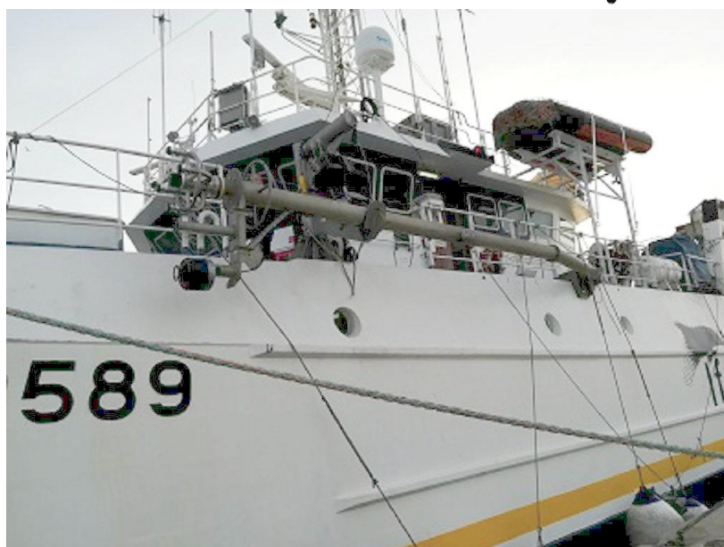
Figure 56 : (haut, gauche) base ultra-courte Posidonia ; (haut, droite) base ultra-courte Gaps ; (bas) perche latérale, à bâbord, pour le déploiement du système des positionnement bases ultra courtes (BUC).
