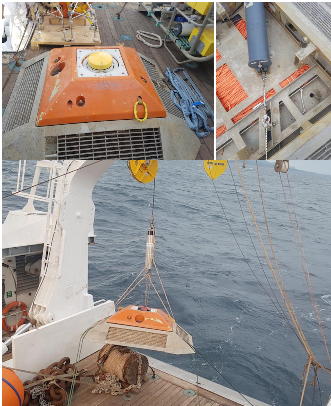
Figure 11 : (haut-gauche) cage antichalutage sur la plage arrière, le couvercle jaune sur le sommet protège l'ADCP ; (haut-droite) balise de largage ; (bas) mise à l'eau de la cage antichalutage.
