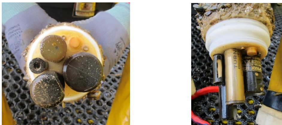
Figure 4 : Etat des capteurs le 17/06/20 à la fin de la campagne 02-2020
