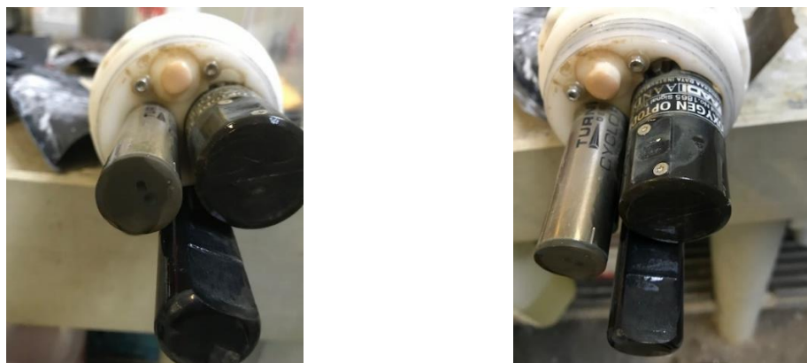
Figure 8 : Etat des capteurs le 05/02/21 à la fin de la campagne 05-2020.
