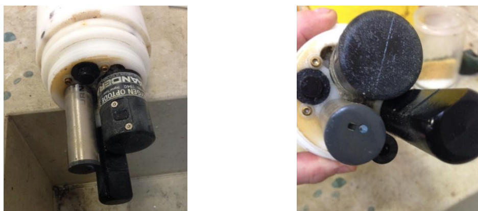
Figure 3 : Etat des capteurs le 29/01/20 à la fin de la campagne 01-2020
