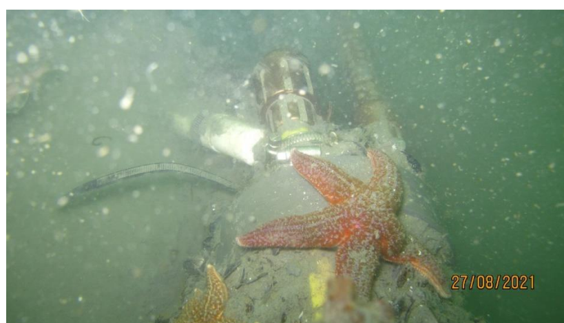
Figure 12 : Crépine de prélèvement de fond posée sur le sédiment – 27/08/2021 Photo : RDT/LDCM - M. Repecaud
