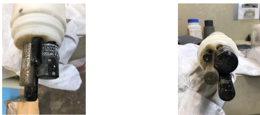
Figure 9 : Etat des capteurs le 07/05/21 à la fin de la campagne de mesure 01-2021.
