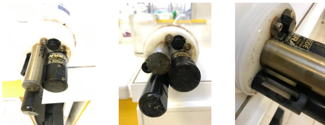
Figure 13 : Etat des capteurs le 30/09/21 à la fin de la campagne de mesure 03-2021.
