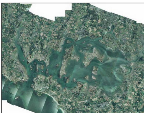
Exemple de discontinuités radiométriques en vue générale du Golfe du Morbihan (extrait de Rollet, 2005)
