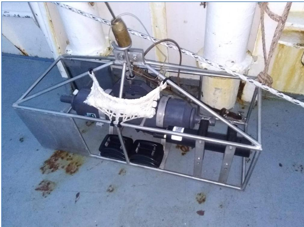
Figure 2 - Cage Niskin pour profils verticaux CTD + Turbidité.
