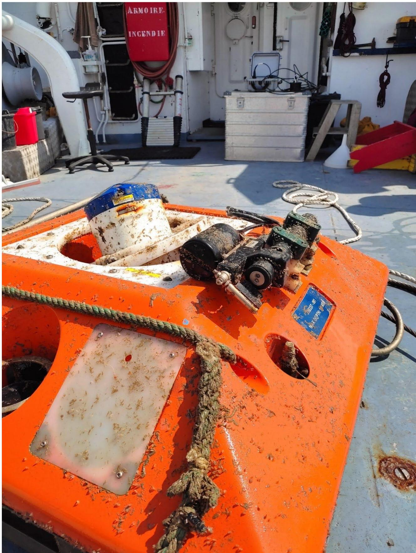
Figure 4 - Récupération flotteur cage AL-200 avec ADCP + turbidimètre
