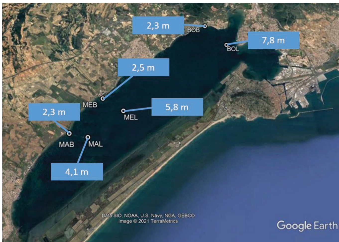
Les stations haute fréquence ont été installées en surface et au fond. Elles mesurent l'oxygène, la température, la pression et l'intensité lumineuse.
