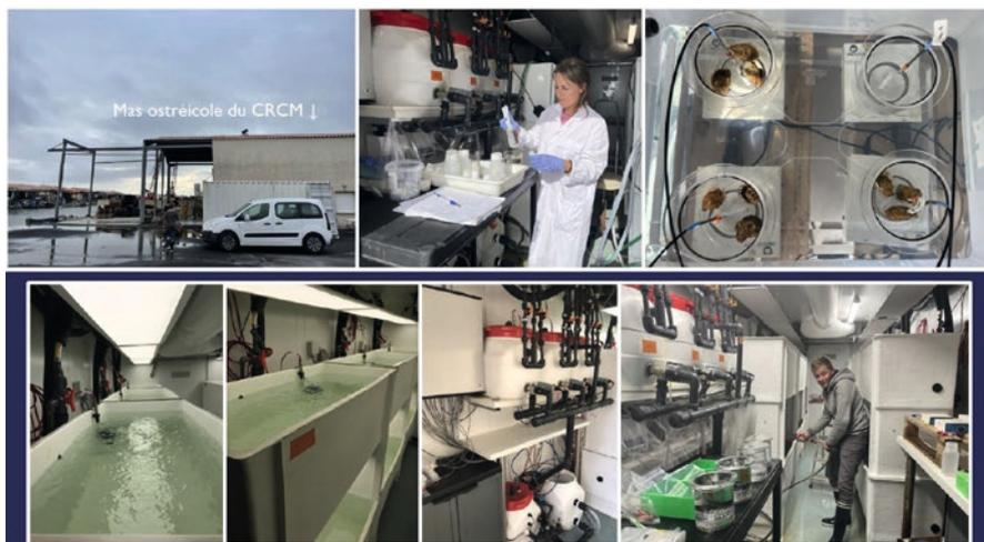
Vue des unités expérimentales installées au mas ostréicole du CRCM, qui comprennent plusieurs bassins dont les conditions de température et d'acidité reflètent l'évolution prévue du climat à horizon 2050, 2075 et 2100.
