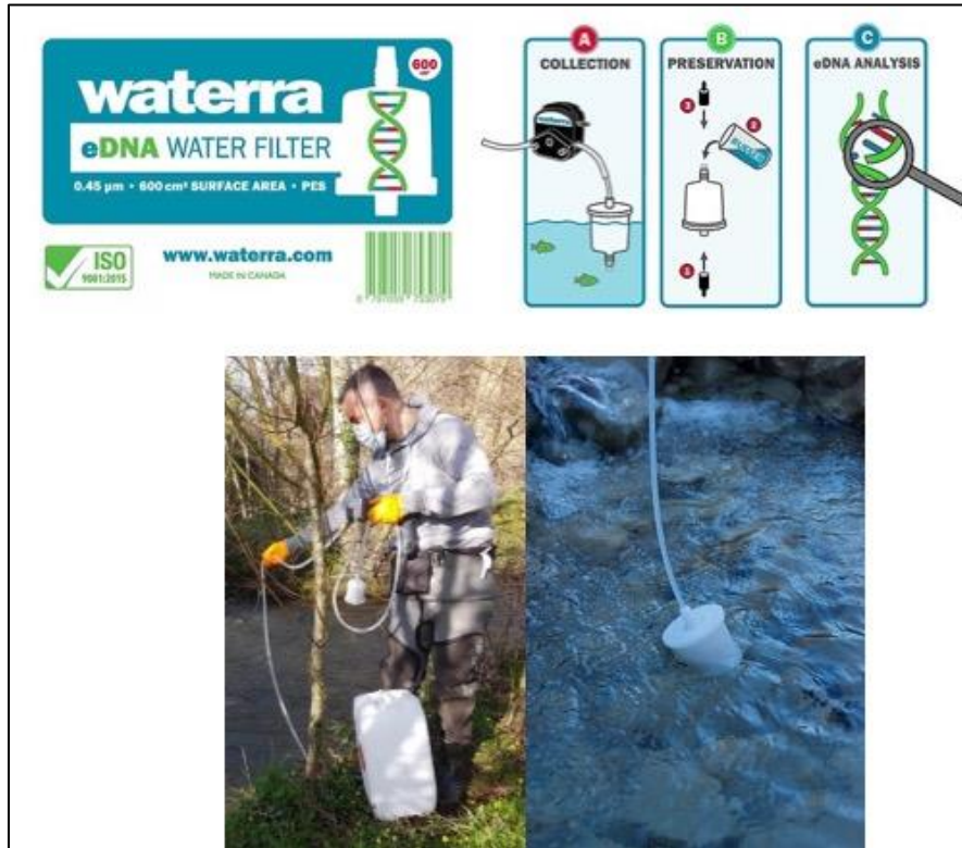
Figure 4 : Filtration in-situ avec capsule Waterra comme préconisé par ARGALY
