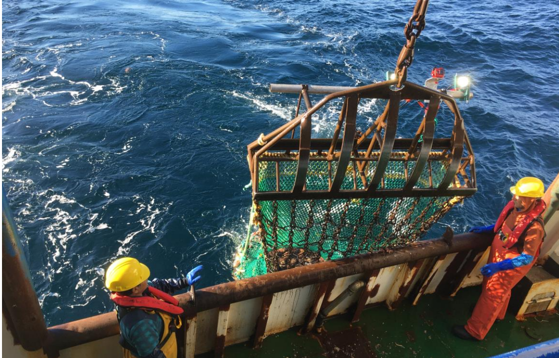
Figure 2 : Drague à concombre modifiée avec 2 spots LED et une caméra
