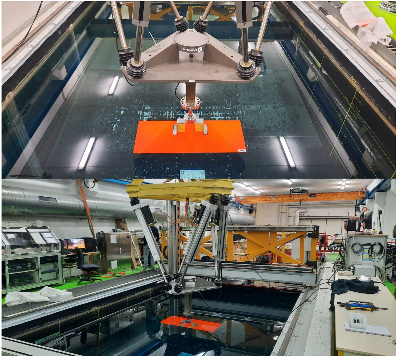
Figures 1a et 1b : Dispositif expérimental en bassin. Du bas vers le haut : profil (orange), étrier et bras, balance d'efforts, bras de liaison entre la balance et le plateau mobile de l'Hexapode.
