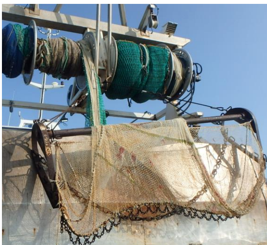
Photo 1 : Chalut à perche de trois mètres avec bourrelet chaîné et racasseur.
