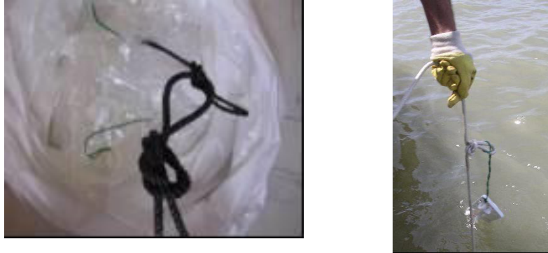
Figure 12 : Fixation du support DGT sur la ligne de mouillage et mise à l'eau.
