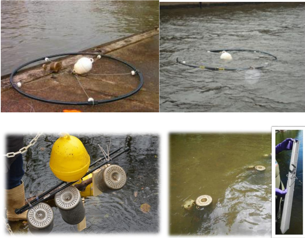
Figure 7. Exemple de dispositifs de déploiement POCIS et SR en cours d'eau
