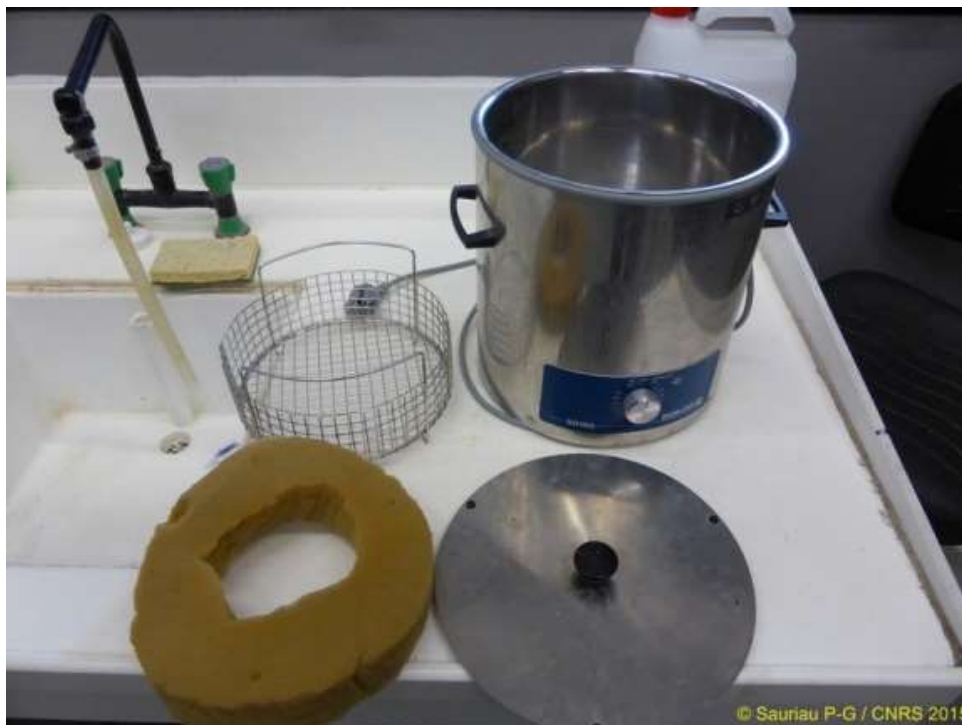
Figure 13 : Bain à ultrasons (A) avec détails du porte tamis et de la collerette en mousse (B) pour maintenir un bol à sédiment. Crédit photos : Sauriau P.-G. / CNRS.
