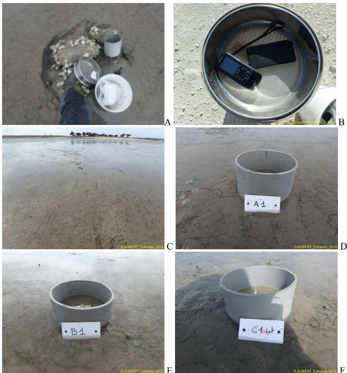
Figure 5 : Matériel (A et B), position générale de la station (C) et prélèvements au carottier sur chacune des 3 sous-stations ou passage (D, E et F). Crédit photos : Aubert F. / Cohabys.
